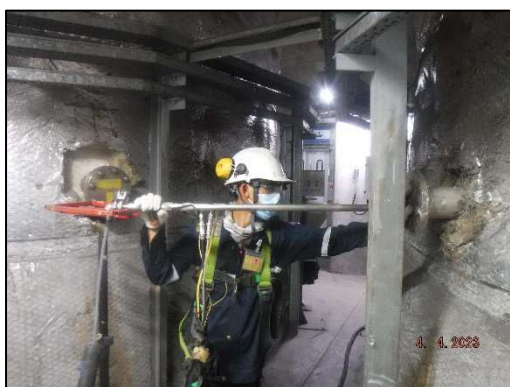
รูปที่ 3-4 การติดตามตรวจสอบปริมาณของสารเจือปนในอากาศที่ระบายออกจากปล่องระบายมลสารของโรงไฟฟ้าหน่วยผลิตที่ 1 เมื่อวันที่ 4 เมษายน พ.ศ. 2566
